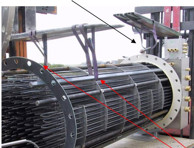
2. Entfernen Sie alle Schrauben aus dem Flansch.
