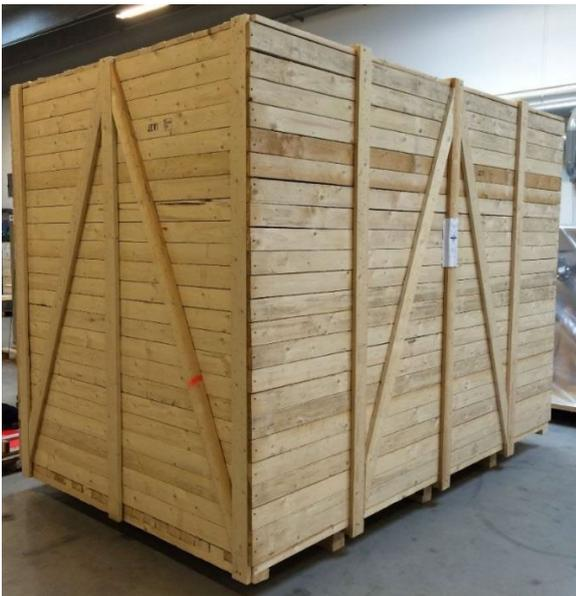
Die Verpackung bietet sowohl mechanischen Schutz als auch Umweltschutz. Wenn das Gerät für den Betrieb im Freien bestimmt ist, wird es, um jedes Risiko von schädlichem Metallstaub während der Lagerung zu vermeiden, mit einer umhüllenden Plastikfolie geschützt. Alle Öffnungen, wie z.B. Kabeleinführungsöffnungen, sind ausreichend abgedichtet.
